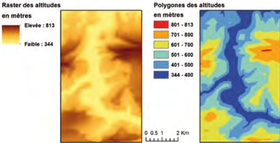
Figure 22 - Représentation d'une même information sous forme d'une couche de données continues (raster des altitudes à gauche) et sa transformation en données discontinues (polygones des classes d'altitudes à droite)
