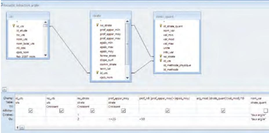
F2-1 – Requête d'extraction de la variable taux d'argile des strates sous Access
