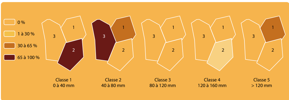
Figure 27 - Agrégation et spatialisation par UCS des valeurs des UTS selon la méthode du pourcentage de chaque classe
