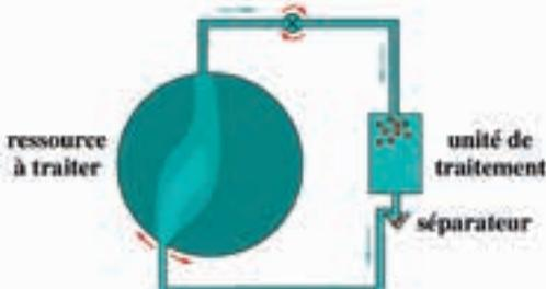
▲ **Principe du traitement en circuit fermé.**
