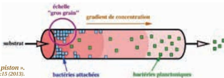
► Schéma d'un bioréacteur de type « piston ». D'après Deygout et al. *Ecological Modelling*, 250:15 (2013).
