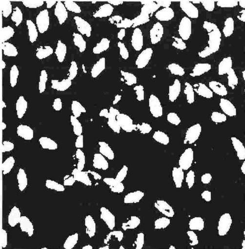
Fig 2 : Une image de grains de blé en vol binarisée.
