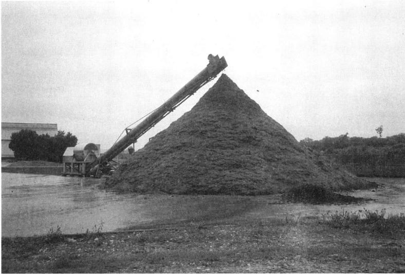
Photo 3 : Le tamisage du lisier présente de nombreux avantages ( tamis limpia ). (photo CEMAGREF, J. Coillard)
