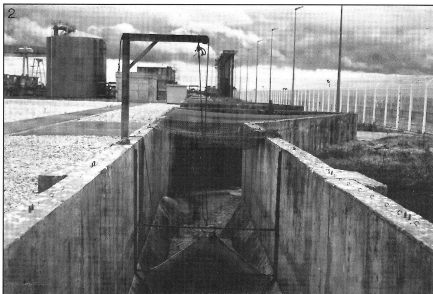
Figure n°30 : Filet expérimental au CPNB prêt à fonctionner (1), en action de pêche (2)
