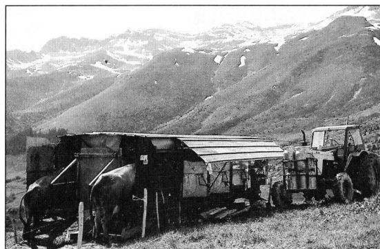
Photo 7. Machines tractées lourdes, certains modèles se présentent comme un tunnel aménagé en salle de traite : 2 x 4 stalles "en épis" placées sur deux quais surélevés, accessibles aux vaches par des rampes extérieures, le trayeur est dans un couloir central
