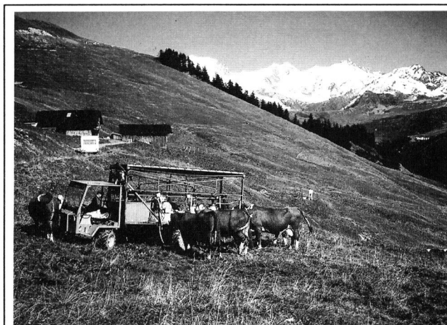
Photo 5. Machine autoportée, en cas de mauvais temps, une bâche de toile se déploie de chaque côté du transporteur pour abriter les trayeurs et les animaux.
