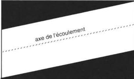
Figure 3.3 : Fenêtre d'intercorrélation, modifiée pour concentrer l'information le long de l'axe de l'écoulement [Kohler, 1992].
