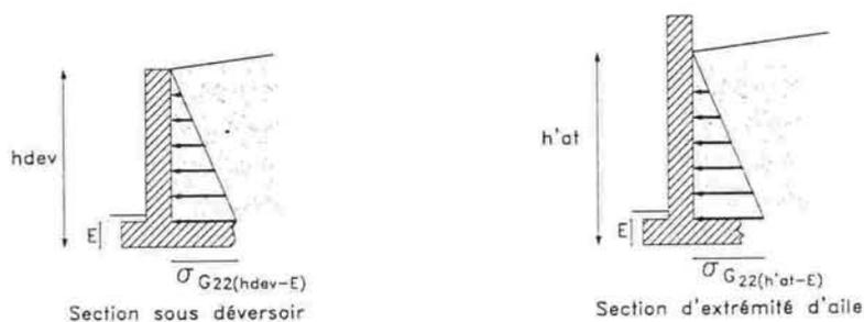
figure 6.28 : diagrammes de poussée par unité de surface de parement du voile des actions prises en compte pour le calcul des sollicitations de sections du voile dans la situation durable considérée
