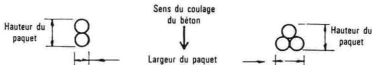
figure 8.19 : bonne disposition des paquets d'armatures
