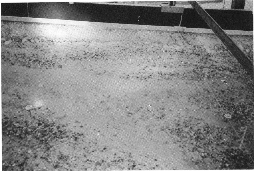
Figure 6-11 : Séparation de l'écoulement en deux bras durant l'essai 15.
