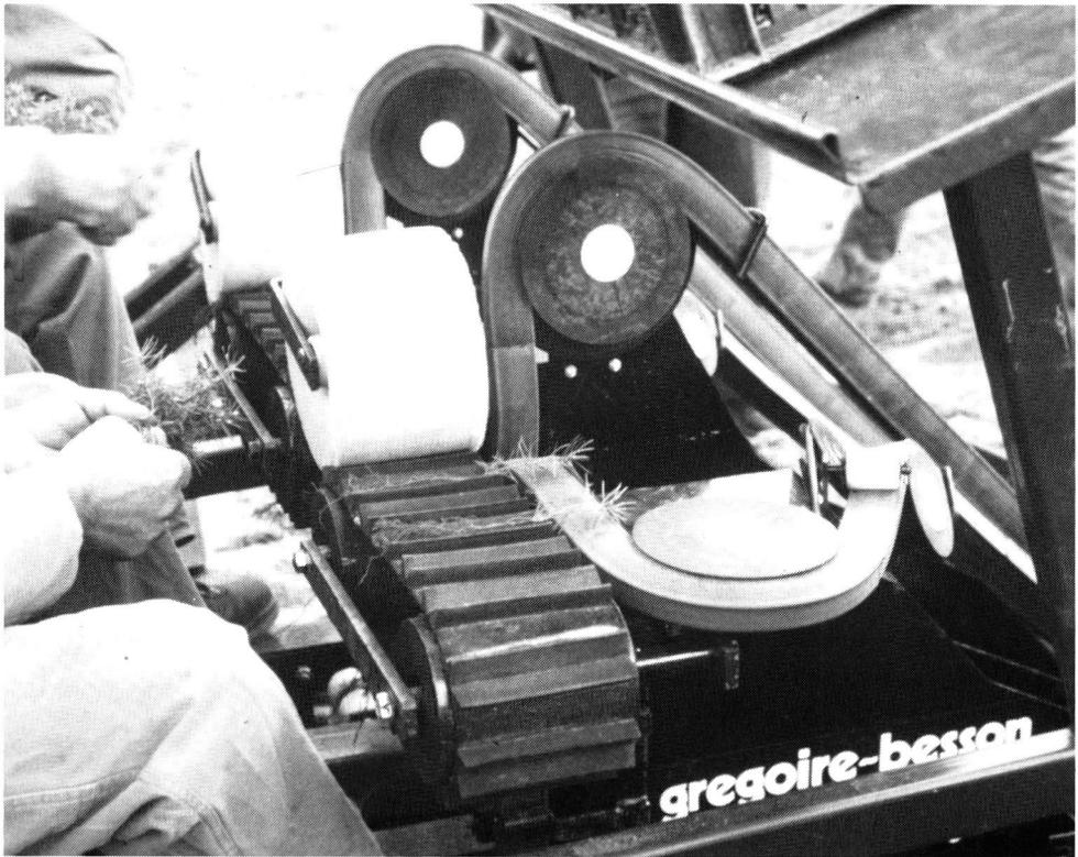
**Photo 4 - Convoyeur principal et convoyeur secondaire avec repères de densité (détail)**
