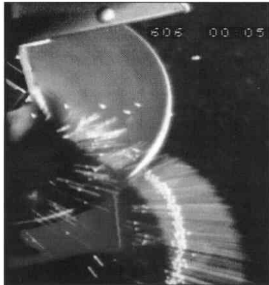
Fig. 28 - Étude de la projection des granulés d'engrais au laboratoire du Cemagref de Montoldre (photo Cemagref)
