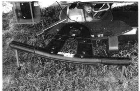
Fig. 69 - Vue des capteurs de mesure de l'angle d'épandage du système Justax® de Sulky (photo Cemagref)
