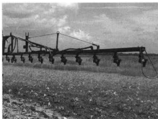
Fig. 162 - Vue des buses d'une rampe de pulvérisation (photo Cemagref)
