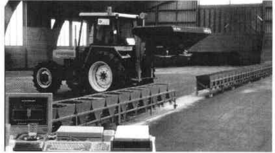
Fig. 79 - Laboratoire du Cemagref pour les essais de distributeurs d'engrais (photo Cemagref)
