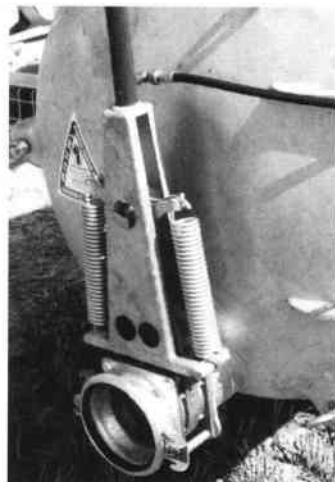
Fig. 142 - Vanne d'épandage à commande hydraulique (photo Cemagref)
