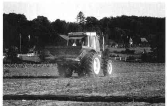
Fig. 80 - Essai au champ d'un distributeur d'engrais, en premier plan la ligne des bacs récepteurs d'engrais (photo Cemagref)
