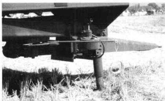
Fig. 107 - Timon d'épandeur muni d'un amortisseur à lames elliptiques (photo Cemagref)
