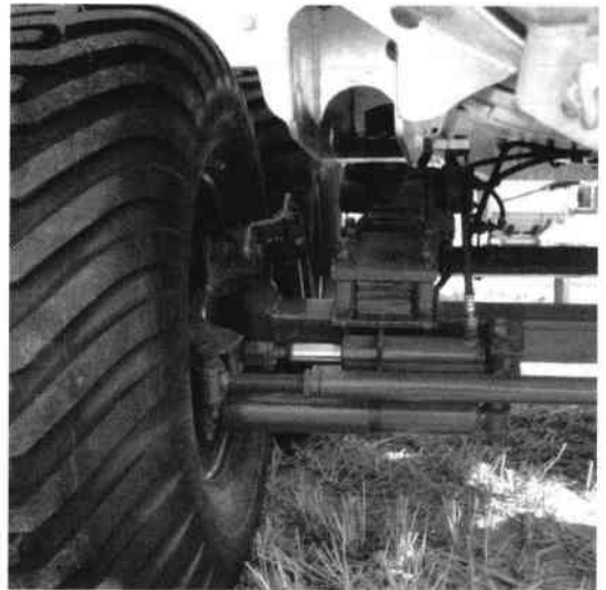
Fig. 106 - Vue d'un essieu directeur à commande hydraulique (photo Cemagref)
