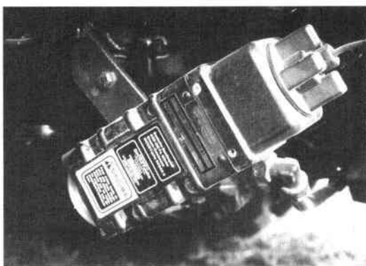
Fig. 66 - Radar pour la mesure de la vitesse réelle d'avancement (photo Cemagref)
