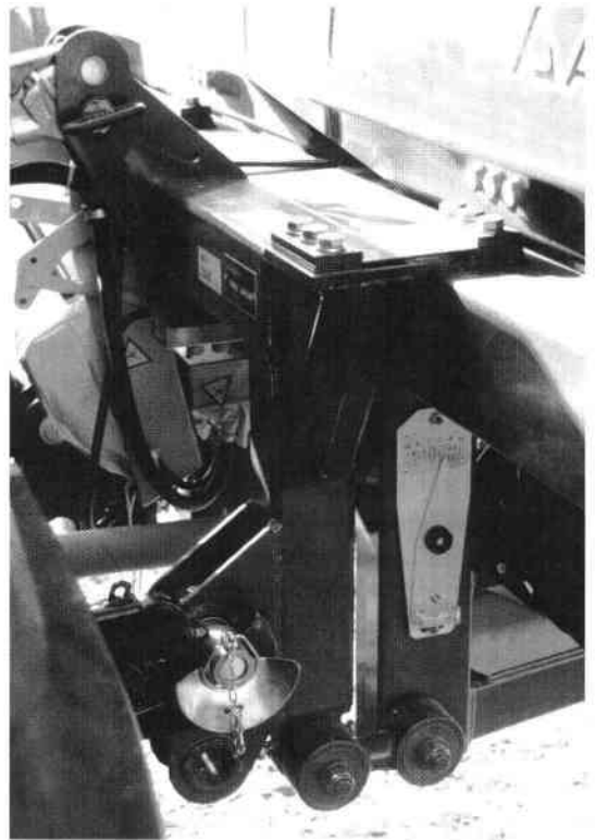
Fig. 67 - Vue du capteur de pesage intégré d'un distributeur Bogballe (photo Cemagref)
