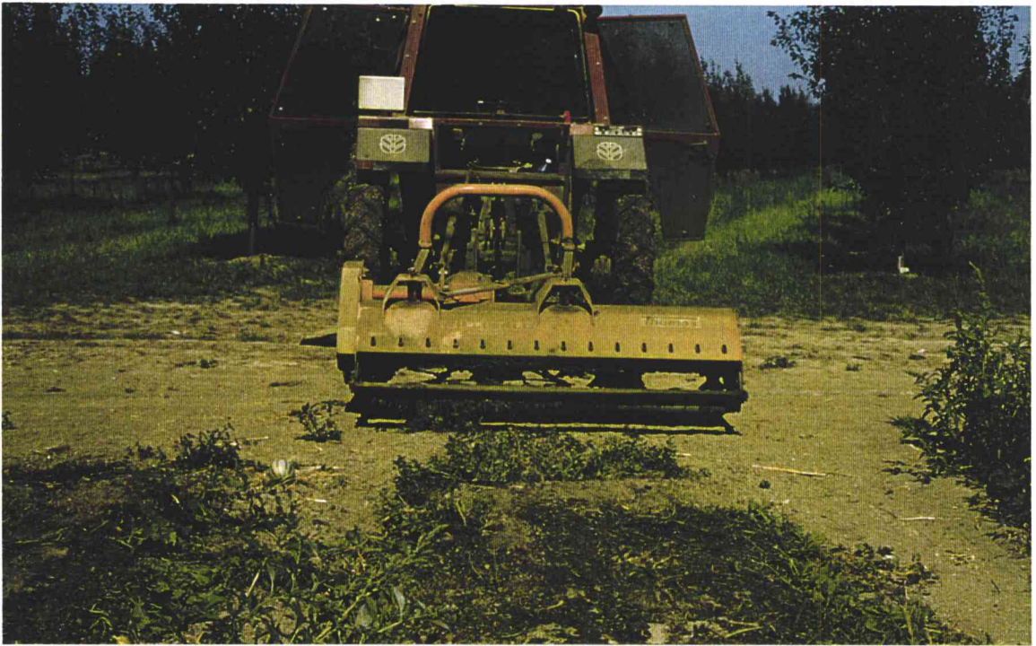
Photo 6 : Broyage de la végétation avec un broyeur classique ; la végétation reste sur le film
