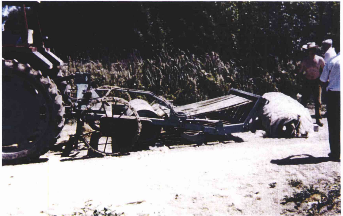
Photo 3 : Ramasseuse de films, marque JAULENT, déposant sa balle ronde
