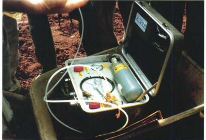
Photo 7.4 : Boîtier de mesure portable pour cellule à contre-pression.
