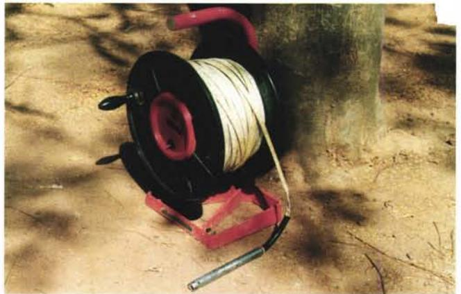
Photo 7.5 : Sonde électrique pour la mesure des niveaux d'eau dans les piézomètres.
