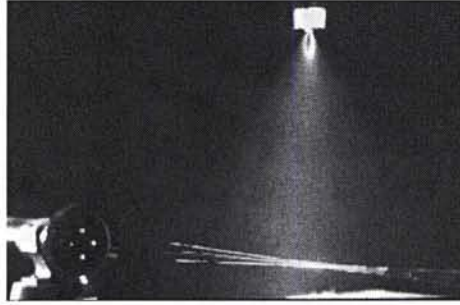
Figure 4 : Mesure de diamètre des gouttes dans un jet par granulométrie vélocimétrie laser
