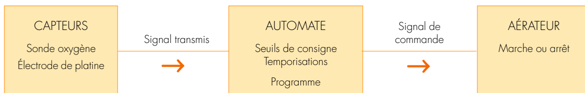
Figure III.3. – Chaîne d'automatisation par asservissement ou régulation
