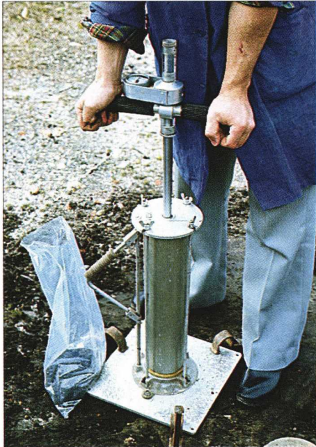
▲ 4 - Contrôle de compactage au densitomètre à membrane...
