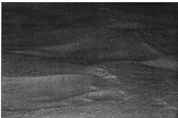
Photographie 11 : particules de PVC humides : suppression de la formation de ripples (cliché F. Naaim / Cemagref)
