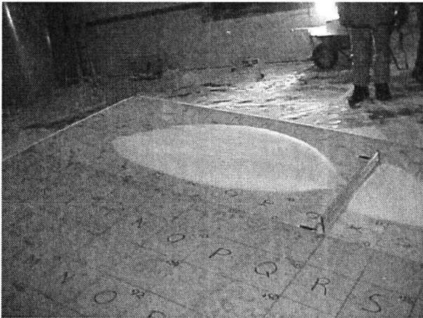
Photographie 23 : accumulation générée par un modèle réduit de barrière à neige dans la soufflerie climatique du CSTB (cliché F. Naaim/Cemagref)
