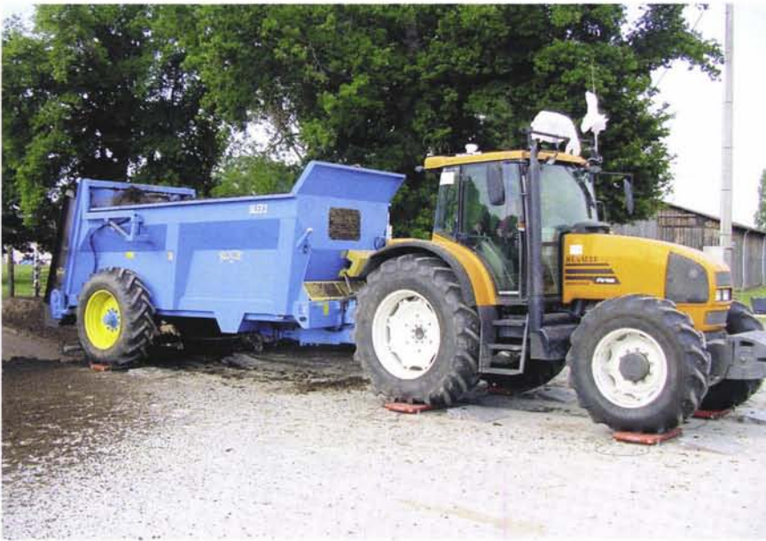
Photo 5.2 – Réalisation de l'essai de régularité longitudinale. [F. Chabot, Cemagref]
