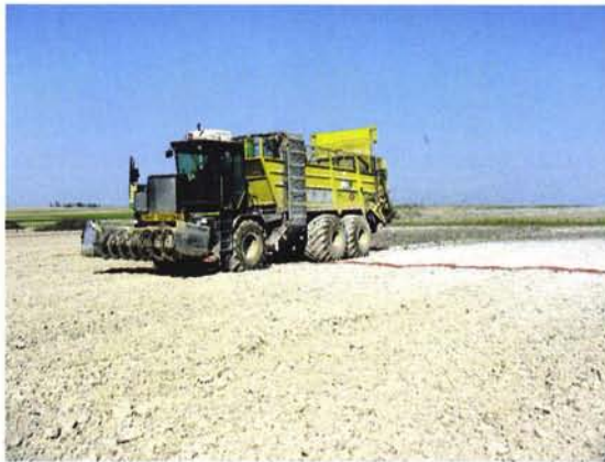
Photo 2.4 – Mesure de répartition au champ. Les boues sont recueillies sur des morceaux de moquette de 50 x 50 cm [F. Thirion, Cemagref]
