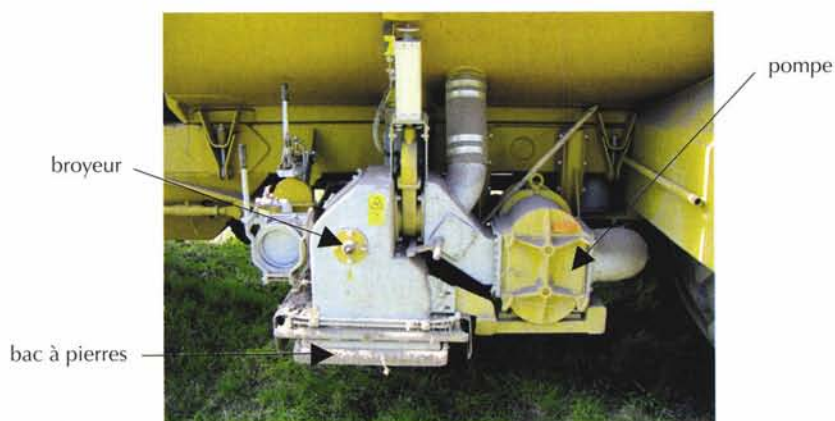
Photo 3.7 – Pompe volumétrique et filtre [F. Chabot, Cemagref]
