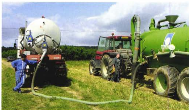
Photo 6.4 – Remplissage de la cuve de l'épandeur par la pompe du camion [F. Chabot, Cemagref]
