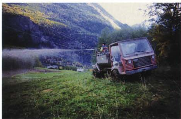
Photo 6.6 – Épandage de boues avec un hydroseeder léger [B. Mallet, LEGTA de Savoie]
