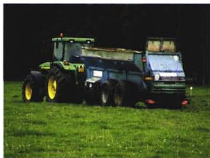
Photo 4.3 – Épandeur évasé (ancien modèle) convenant à l'épandage des boues pâteuses plastiques [J. Mazoyer, Cemagref]
