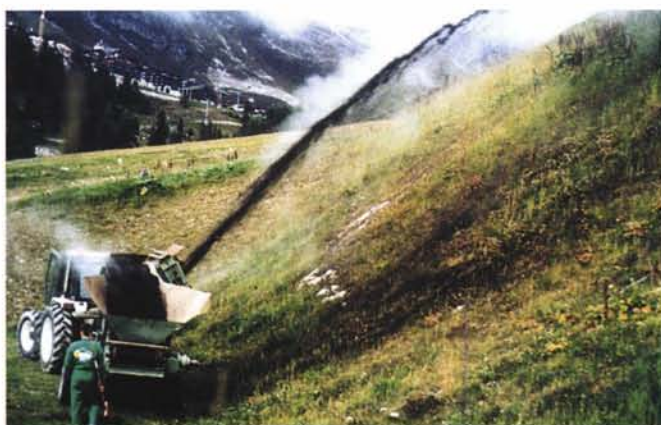
Photo 6.7 – Machine destinée à épandre le compost par projection [F. Dinger, Cemagref]
