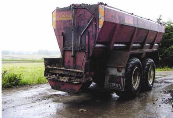
Photo 4.1 – Épandeur spécifique de boues pâteuses [F. Thirion, Cemagref]
