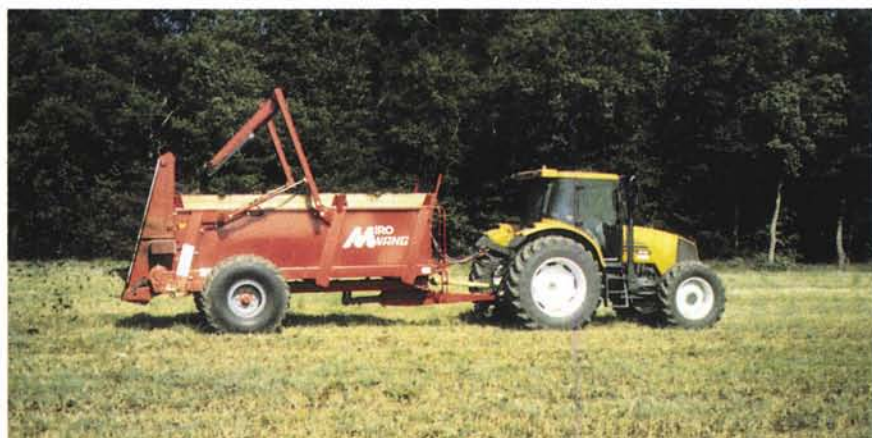
Photo 5.3 – Épandage de fumier avec un épandeur à hérissons verticaux [J. Mazoyer, Cemagref]
