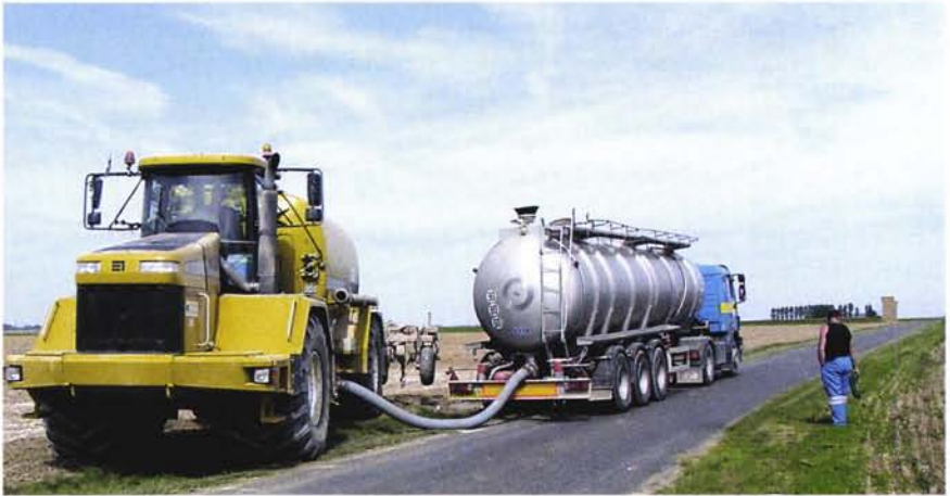
Photo 6.3 – Remplissage de la cuve de l'épandeur par sa pompe. Le camion et l'épandeur restent propres [F. Thirion, Cemagref]
