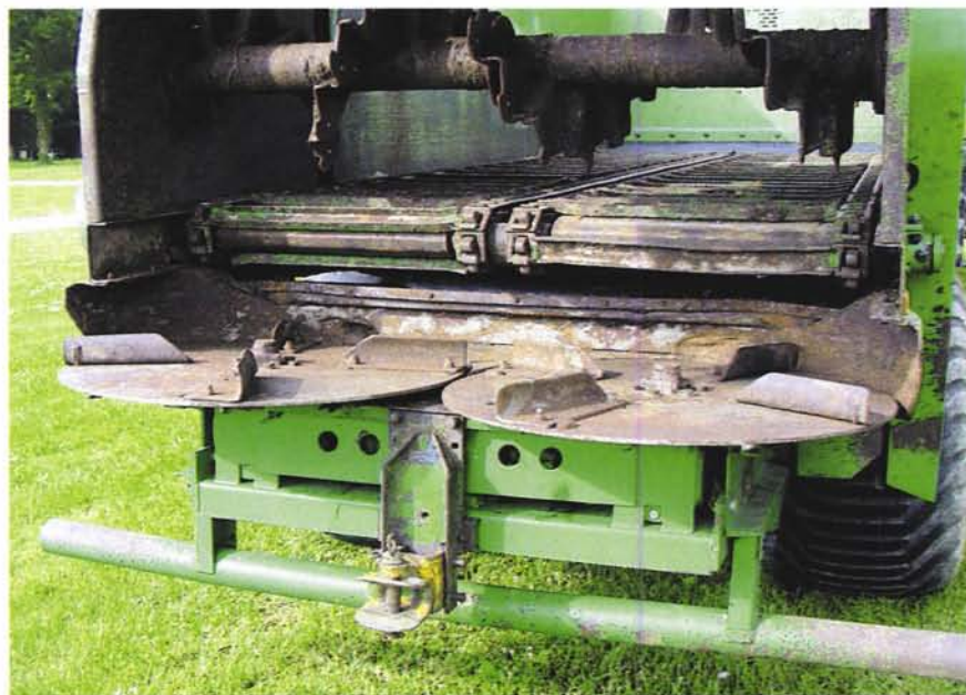
Photo 5.4 – La table d'épandage à deux disques de l'épandeur Tebbe HKS 100 [F. Chabot, Cemagref]
