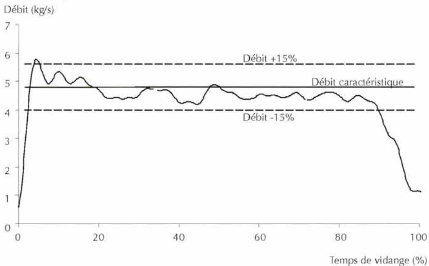
Figure 5.24 – Courbe de variation du débit durant le temps de déchargement (épandeur Rock GRP 75)
