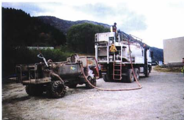
Photo 6.5 – Hydroseeder léger (terrains difficiles) et hydroseeder lourd (terrains faciles) [B. Mallet, LEGTA de Savoie]
