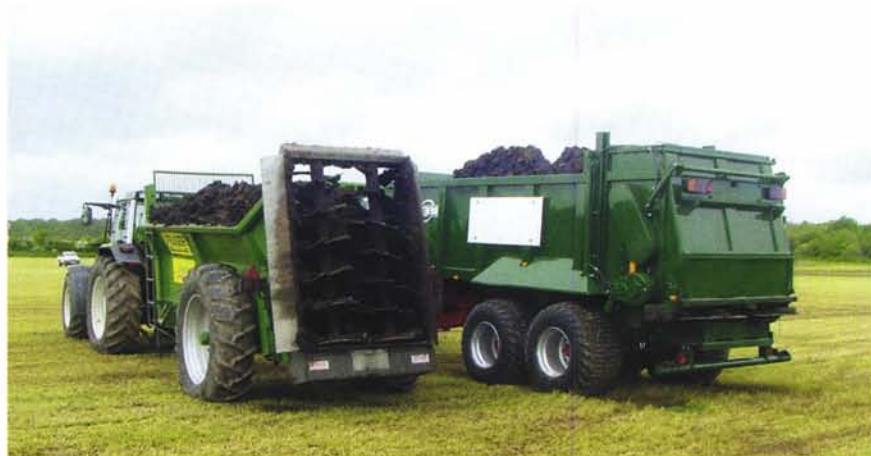
Photo 5.1 – Les deux types principaux d'épandeurs de produits solides [F. Gaillard, Cemagref]
