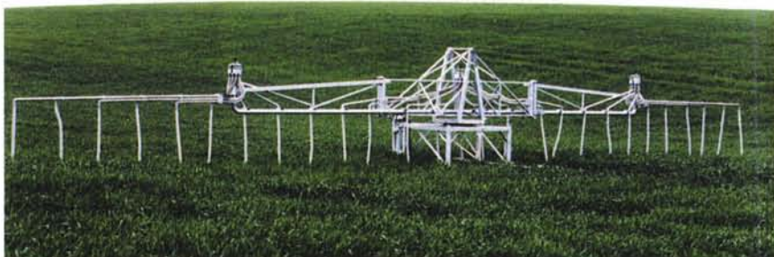
Photo 3.3 – Rampe 24 m à trois répartiteurs [M. Plantié, Terres du Sud]
