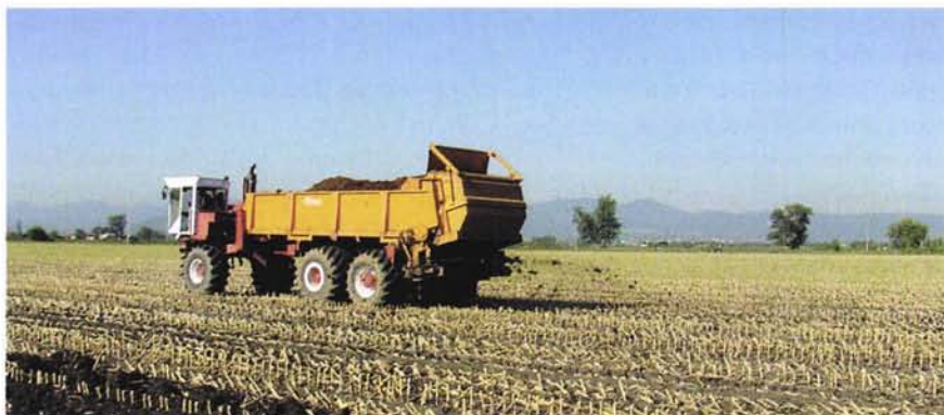
Photo 5.6 – Épandeur automoteur à table d'épandage [F. Thirion, Cemagref]
