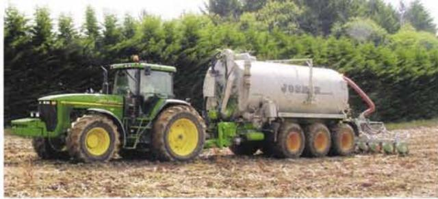
Photo 3.6 – Épandage par tonne à lisier [F. Chabot, Cemagref]
