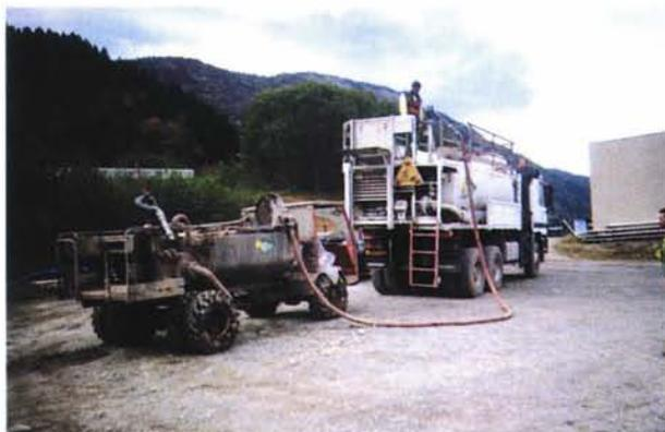
Photo 6.5 – *Hydroseeder* léger (terrains difficiles) et *hydroseeder* lourd (terrains faciles)
