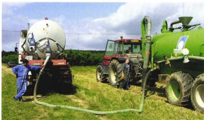
Photo 6.4 – Remplissage de la cuve de l'épandeur par la pompe du camion
