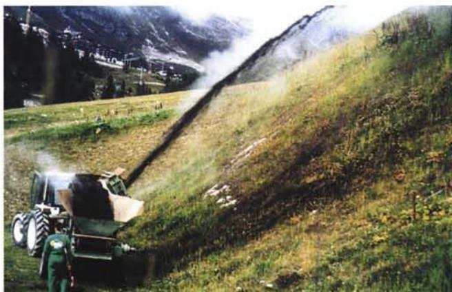
Photo 6.7 – Machine destinée à épandre le compost par projection
