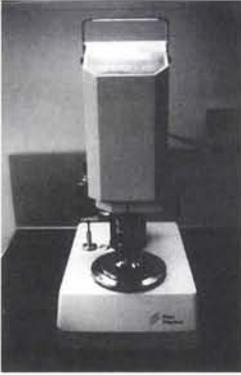
rhéomètre consiste à déterminer le couple nécessaire à la rotation d'un mobile (cf. photo 1.9). La vitesse de rotation et l'épaisseur de liquide déterminent le gradient de vitesse.
