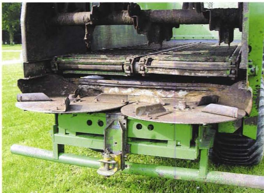
Photo 5.4 – La table d'épandage à deux disques de l'épandeur *Tebbe HKS 100*
