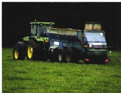
Photo 4.3 – Épandeur évasé (ancien modèle) convenant à l'épandage des boues pâteuses plastiques [J. Mazoyer, Cemagref]
