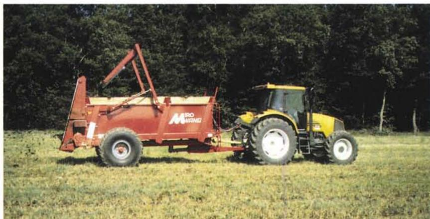
Photo 5.3 – Épandage de fumier avec un épandeur à hérissons verticaux
