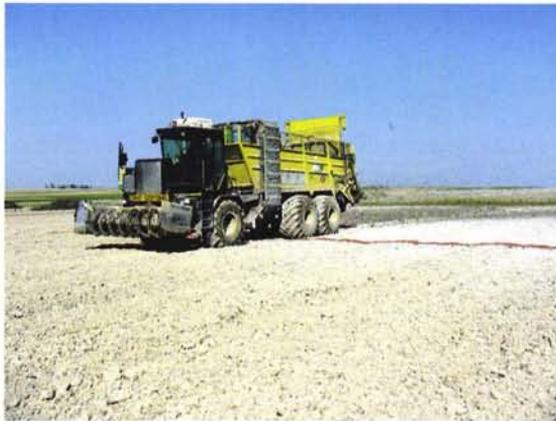
Photo 2.4 – Mesure de répartition au champ. Les boues sont recueillies sur des morceaux de moquette de 50 x 50 cm [F. Thirion, Cemagref]
