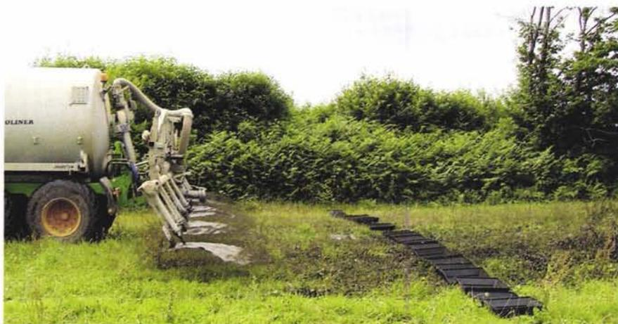
Photo 3.8 – Épandage avec rampe à buses [F. Chabot, Cemagref]
