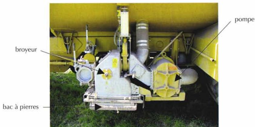
Photo 3.7 – Pompe volumétrique et filtre [F. Chabot, Cemagref]
