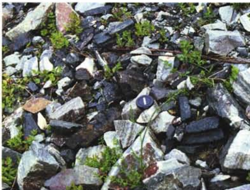
Photographie 11 – Un exemple de riprap hétérogène. Noter la forte proportion de ballast favorable à la ségrégation des matériaux à la pose.
