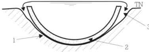
Figure 50 – Coupe schématique du coursier de l'évacuateur de crues du barrage de BOUSQUET (Lot-et-Garonne).
