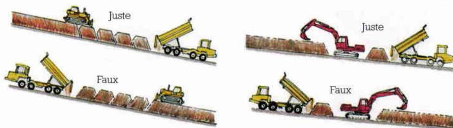
Figure 39 : Mise en place du sous-sol de haut en bas (d'après [62 a]).
