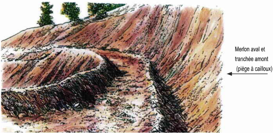
Figure 69 : Banquette en préparation avec merlon aval et tranchée amont [TPG 11].
