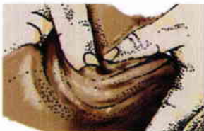
Figure 38 : Détection de la limite de plasticité d'un sol.
