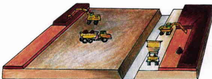
Figure 42 : Schéma de décapage avec dumpers et pelles.
