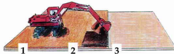
Figure 43 : Schéma de régalage avec pelle à chenille.
