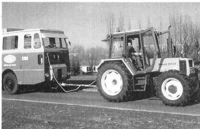
Fig. 290 — Essai de traction au CEMAGREF : le tracteur est relié au véhicule-frein par une barre dynamométrique (Photo CEMAGREF).
