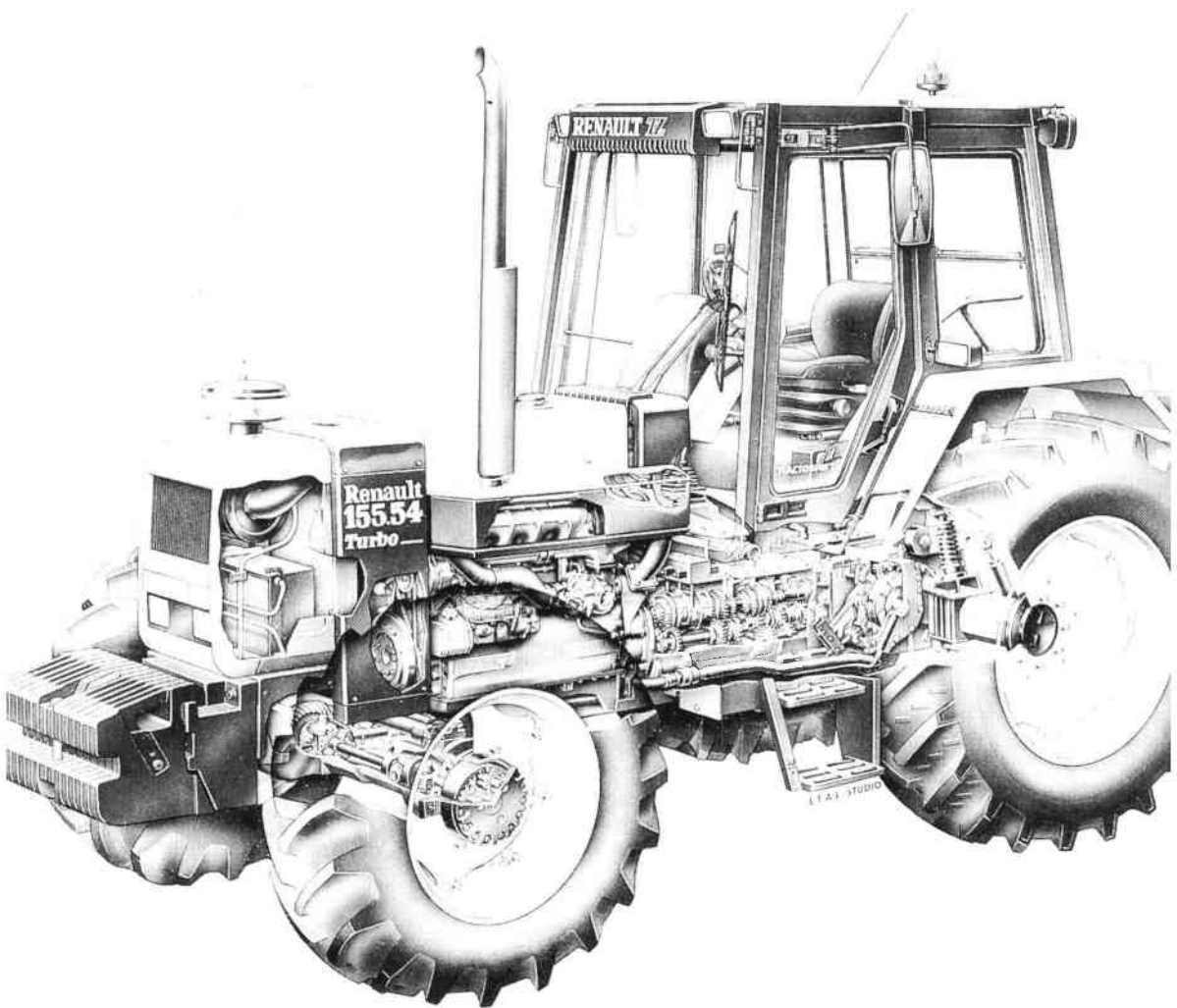
Vue en coupe d'un tracteur Renault 155.54, avec cabine suspendue, RENAULT AGRICULTURE (création ETA1 studio).
