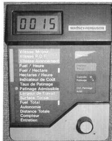
Fig. 66 – Console du système « datatronic » Massey-Ferguson avec contrôle de glissement à taux ajustable (Photo Massey-Ferguson).
