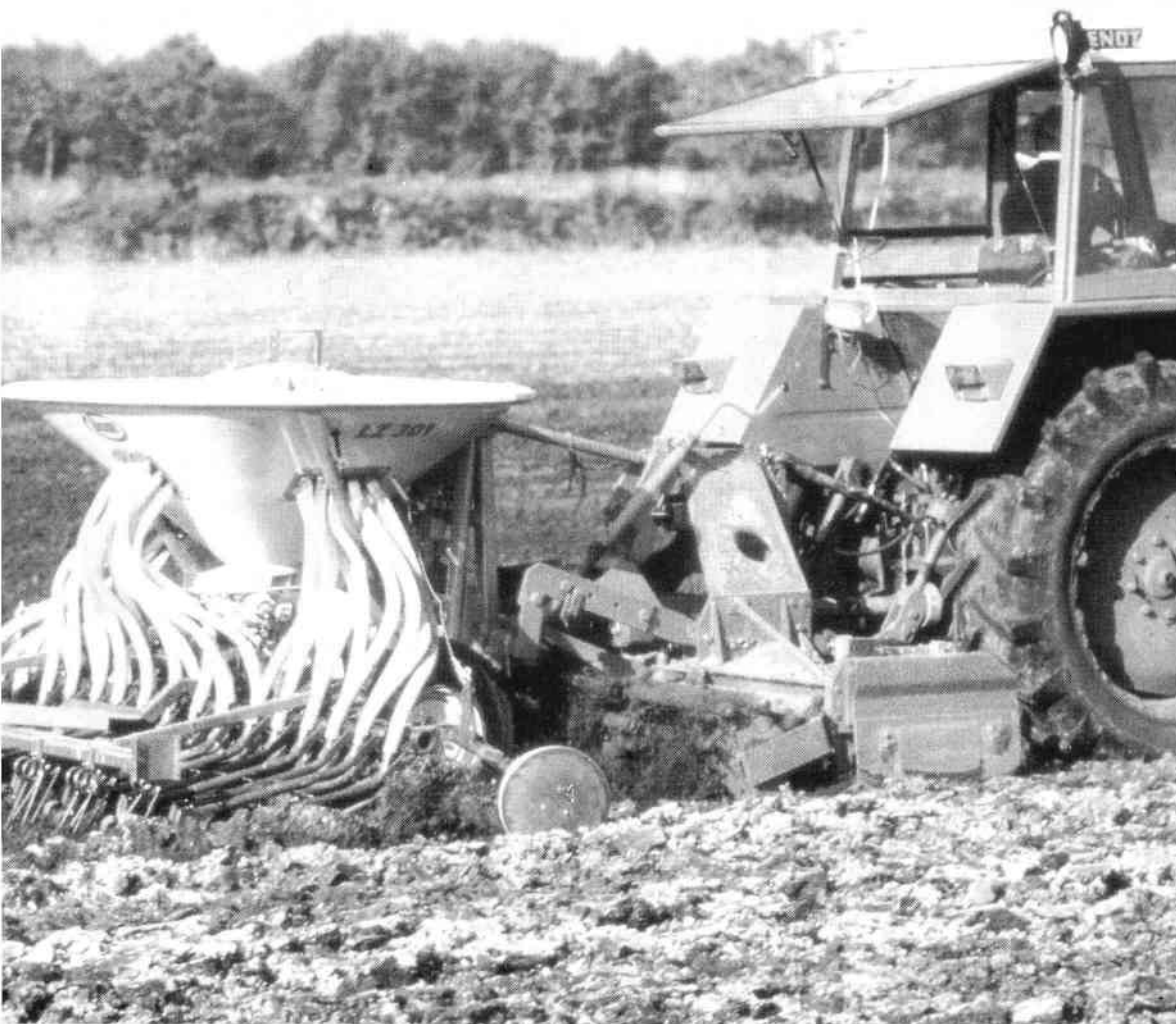
Train d'outils combinés pour le travail du sol et le semis (Photo VICON).
