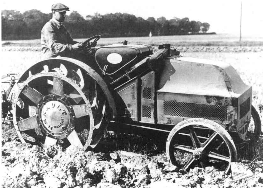
Fig. 3 — Tracteur à essence Renault HO de 1921 : 4 cylindres 20 Ch à 1 600 tr/mn, 2 100 kg (Document Renault Agriculture).
