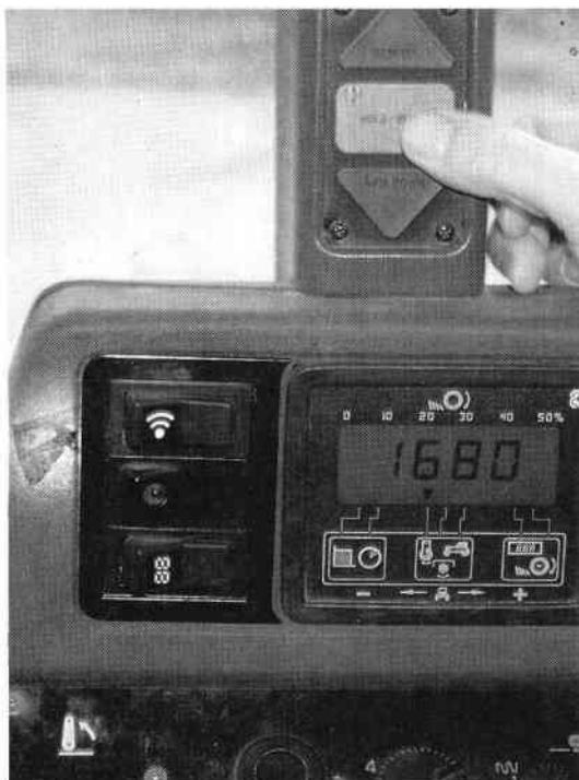
Fig. 104 — Vue de la commande d'un régulateur électronique SAME (Photo R. Autellet).
