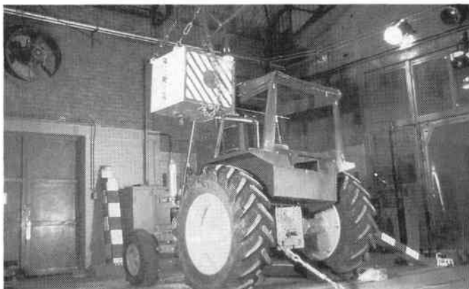
Fig. 287 — Essai dynamique de résistance d'une cabine de sécurité au CEMAGREF (Photo CEMAGREF)
