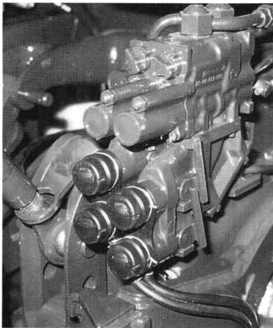
Fig. 256 — Distributeur auxiliaire avec régulateur de débit intégré (Photo CEMAGREF-DICOVA).
