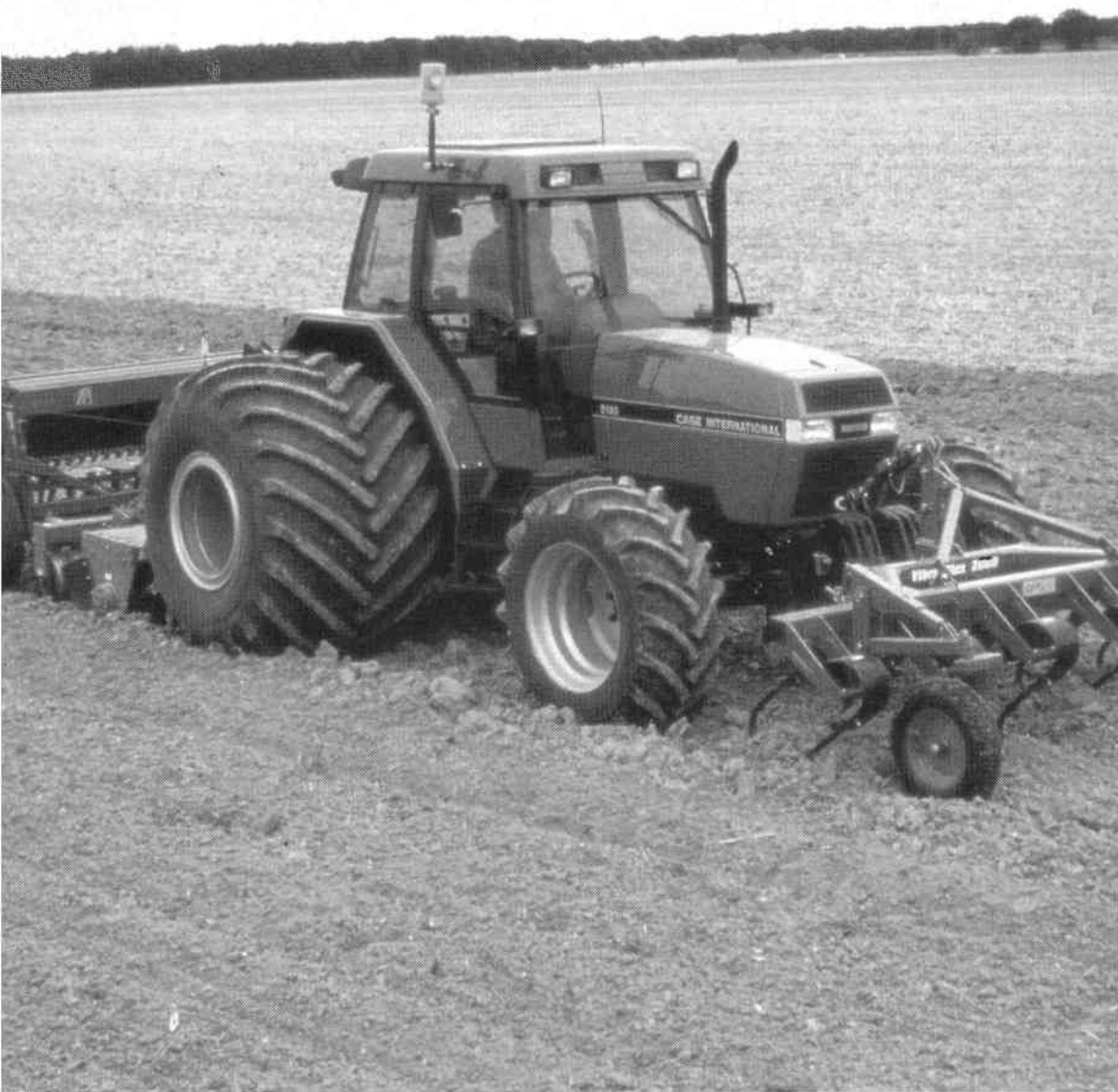
Travail du sol et semis avec tracteur équipé de pneumatiques de grande largeur (Photo CASE IH).
