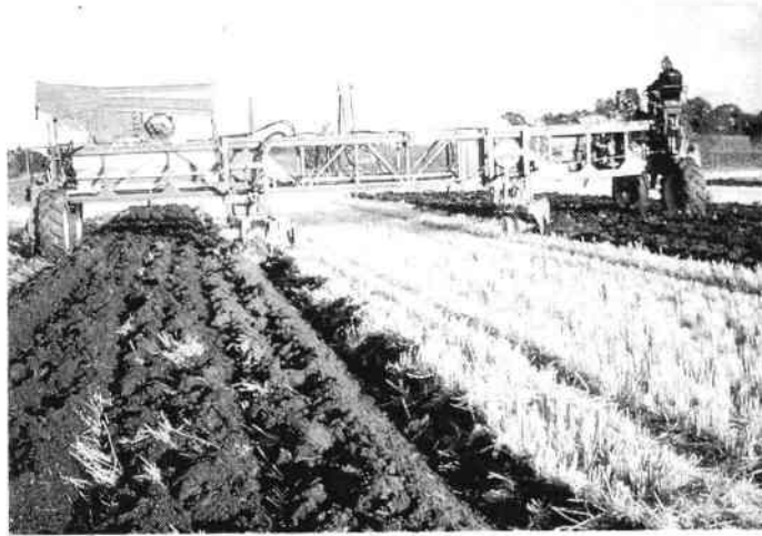
Fig. 11 — Tracteur portique (gantry system) conçu et expérimenté en Angleterre au Silsoe Research Institut (Photo Silsoe Research Institut).
