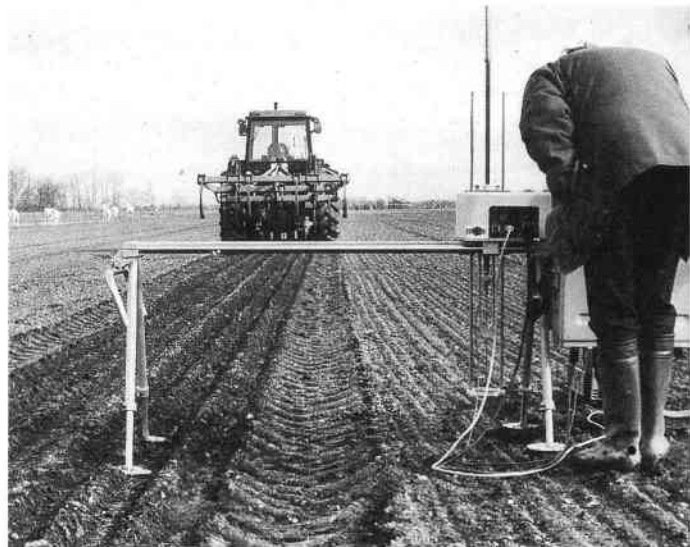
Fig. 183 — Vue d'un pénétrromètre automatique (Photo CEMAGREF).
