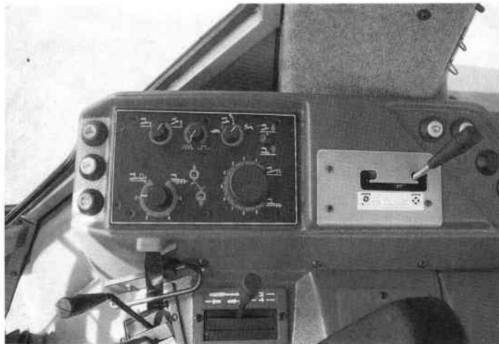
Fig. 252 — Console d'un relevage à commandes électroniques (Photo Massey-Ferguson).
