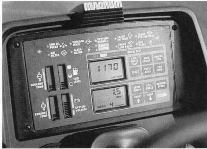
Fig. 63 — Tableau de bord Case IH avec indicateur de vitesse réelle d'avancement et de patinage (Photo Case IH).
