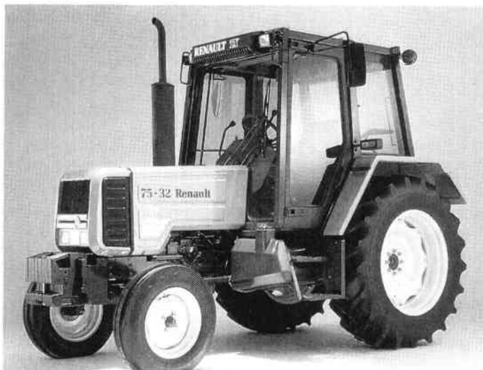
Fig. 5 – Tracteur à deux roues motrices (Photo Renault – Jean Biaugeaud).
