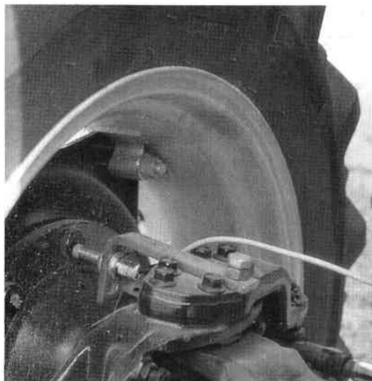
Fig. 42 — Vue d'un capteur à courants de Foucault (Photo CEMAGREF-DICOVA).
