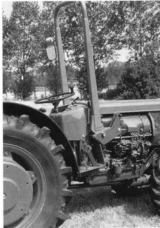
Fig. 21 — Tracteur étroit avec arceau de sécurité rabattable (Photo CEMAGREF-DICOVA).
