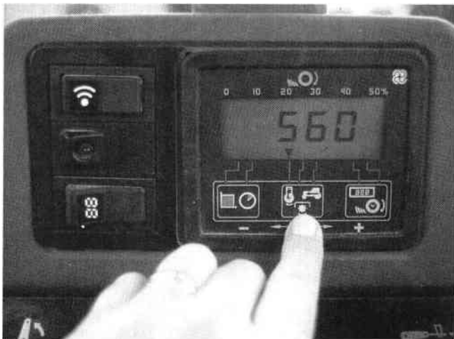
Fig. 65 – Console d'un contrôleur de glissement à taux fixe SAME (Photo R. Autellet).
