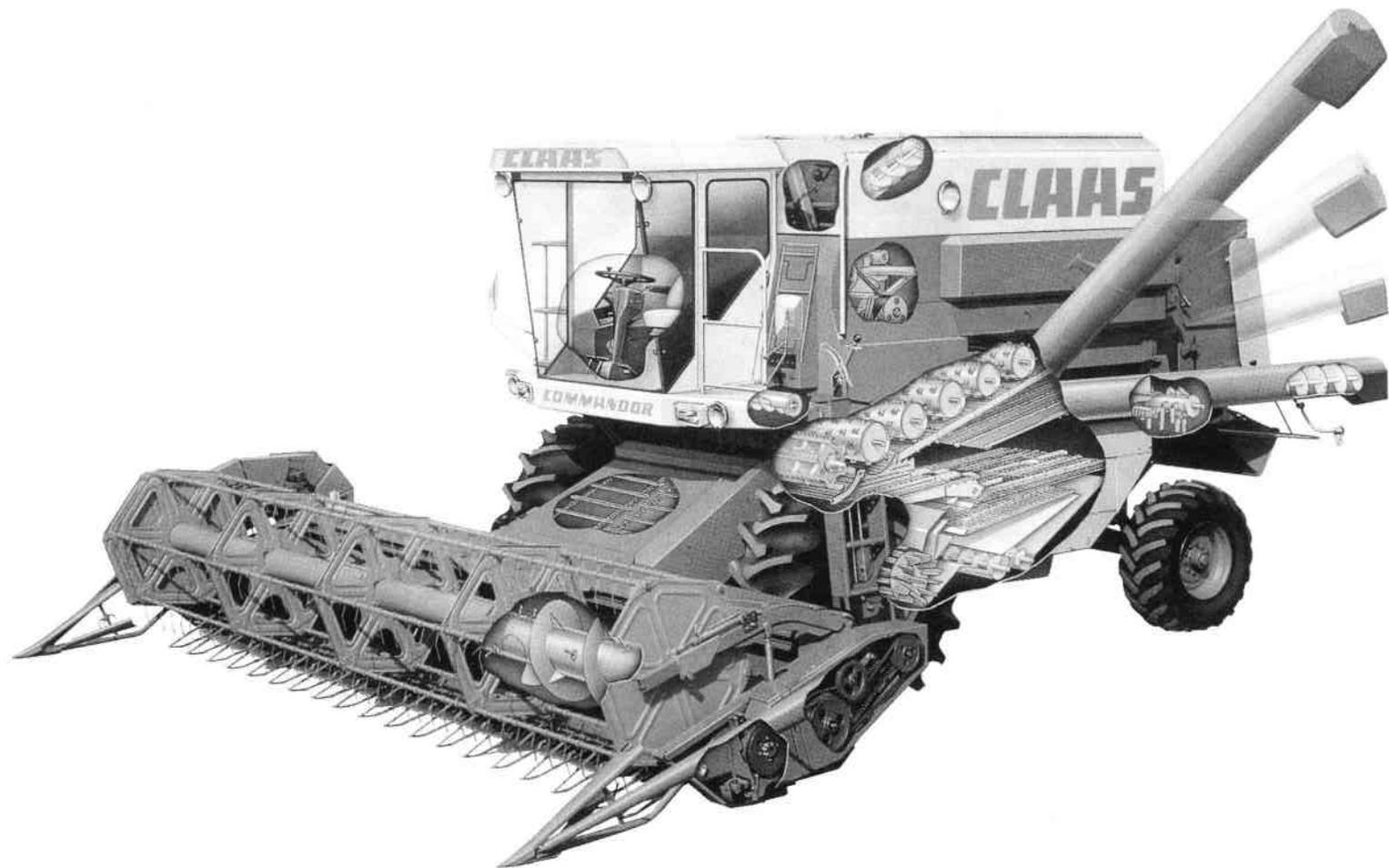
**Vue en coupe d'une moissonneuse-batteuse Claas "Commandor CS",
