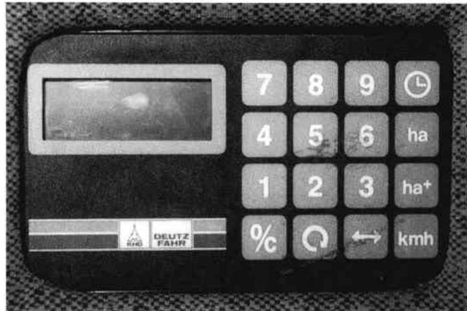
Fig. 200 — Console d'un ordinateur de bord Deutz-Fahr.
