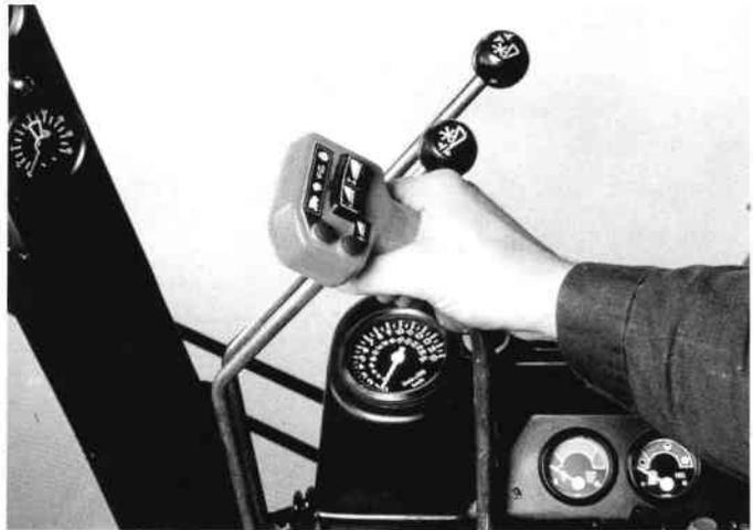
Fig. 171 — **Levier combiné : fonctions machine et avancement.**
