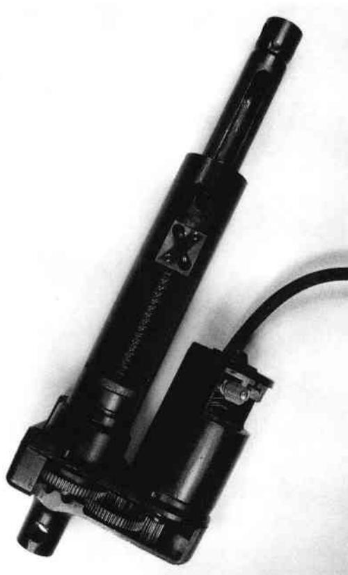
Fig. 161 — **Vue en coupe d'un vérin électrique** (coupe et photo CEMAGREF).
