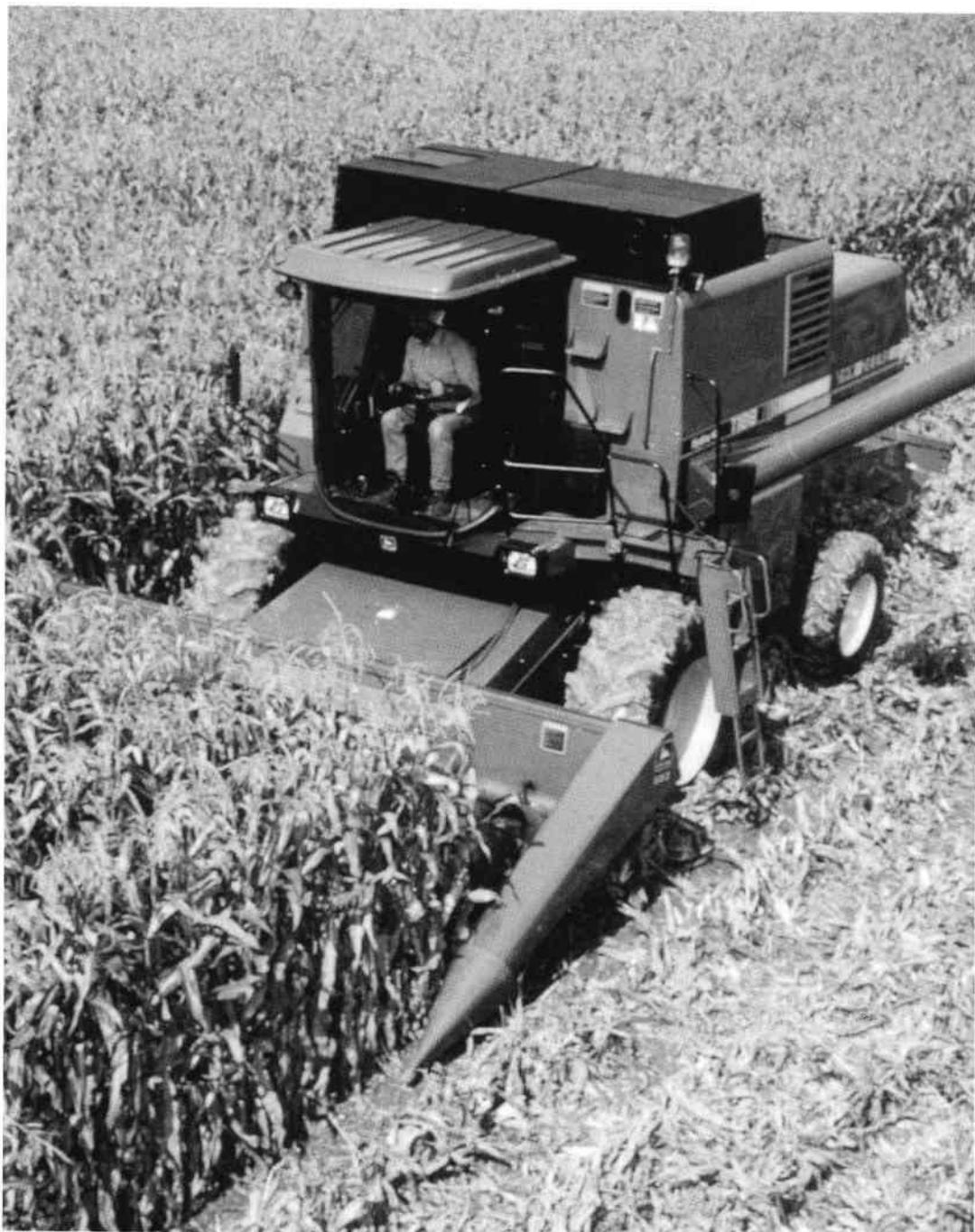
Récolte de maïs-grain avec une moissonneuse-batteuse équipée d'un cueilleur à 5 rangs,
