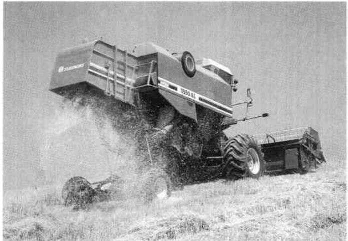
Fig. 97 — **Moissonneuse-batteuse Fiatagri, à châssis correcteur de pente et de dévers.**
