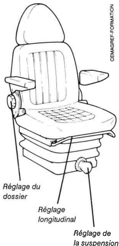
Fig. 227 — **Siège suspendu.**
