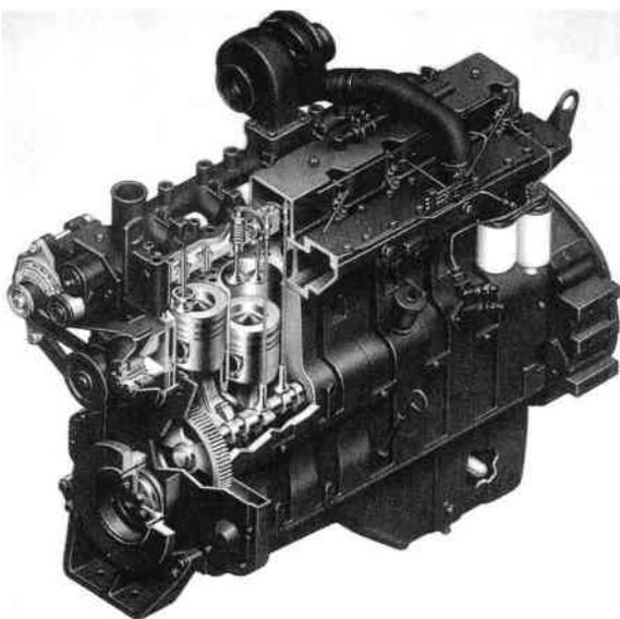
Fig. 155 — **Vue en coupe d'un moteur diesel Case IH.**
