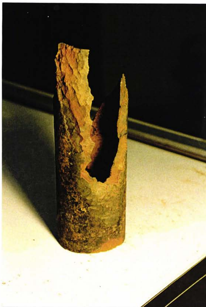
Figure A3 : Photographie représentant une conduite ayant subi une rupture.
