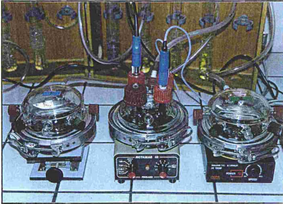
Figure 1 : Cellule de mesure en verre de faible profondeur équipée d'un ensemble d'électrodes (pH, conductivité et température).
