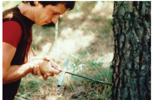
Prélèvement d'une carotte de bois à la tarière de Pressler
