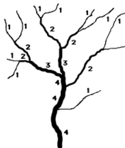
Figure 2 - Méthode d'ordination des cours d'eau selon Strahler (1957)
