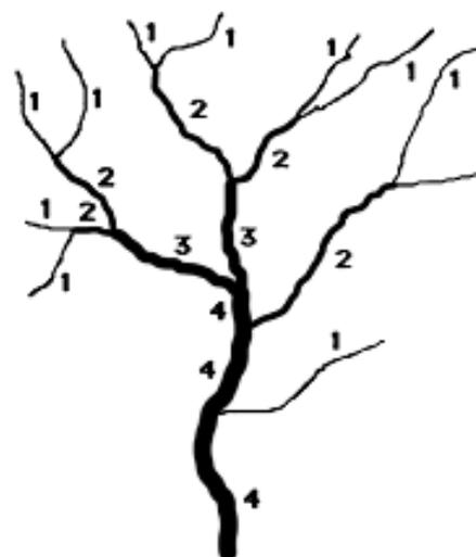
Figure 2 - Méthode d'ordination des cours d'eau selon Strahler (1957)
