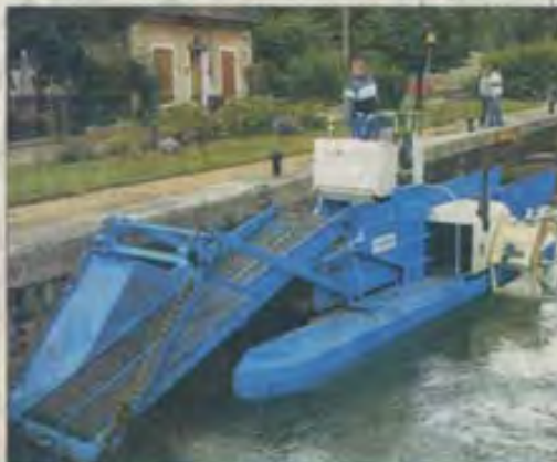
Équipe de faucardage verticale, horizontale et d'un tapis roulant, cette faucarde agit moderne soit soit se représente qu'un traitement court puisque les algues sont emmenées déchèterie et non arrachées.
