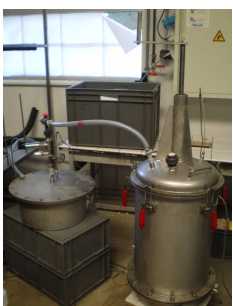
Photo 3: Connexion des deux cellules pour la mesure du FAS
