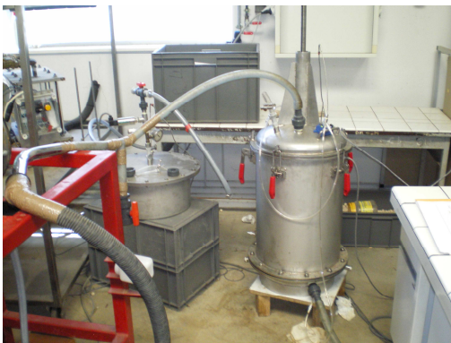
Photo 4: Cellule échantillon connectée pour la mesure de perméabilité
