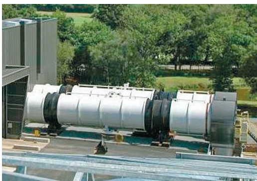
▲ Photo 1 – Les tubes de précompostage de l'usine de Launay-Lantic.
