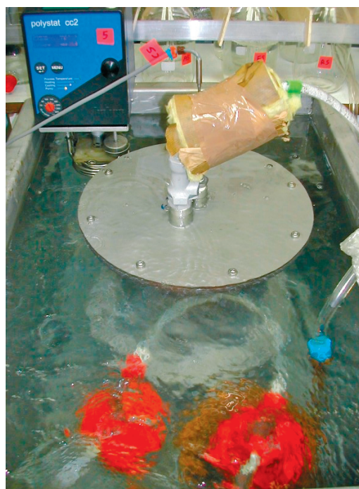
◀ Photo 3 – Cellule respirométrique en inox de 10 l en cours de fonctionnement, dans son bain thermostaté.
