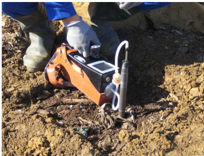
Figure 25 : Mesure in-situ des gaz du produit par sonde et analyseur multi-paramètres Ecoprobe 5
