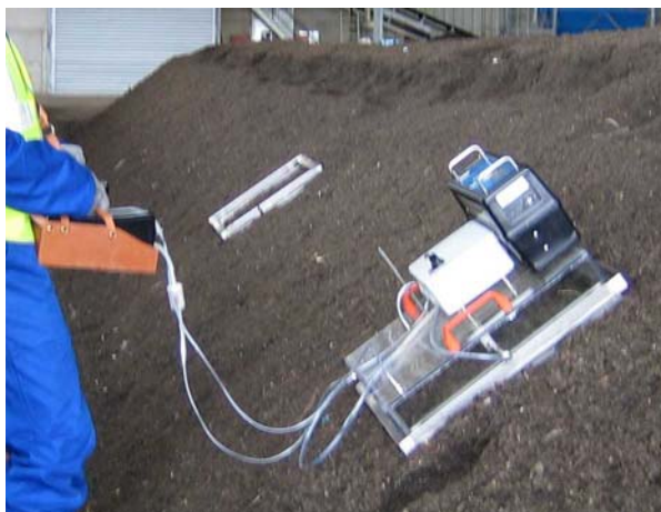
Figure 10 : Dispositif de mesure de flux : analyseur FID posé sur la chambre à accumulation, analyseur multi-paramètres (IR + PID) tenu à la main
