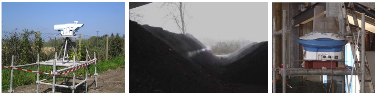
Figure 62 : Photos descriptives de l'installation de l'émetteur et du récepteur du DOAS sur le site A
