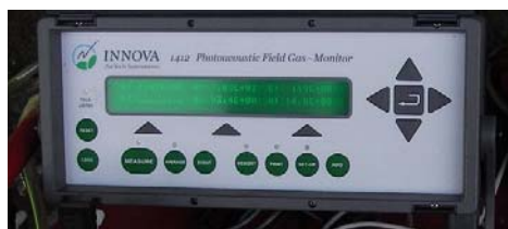
Figure 12 : Analyseur multi-gaz INNOVA 1412 (façade)
