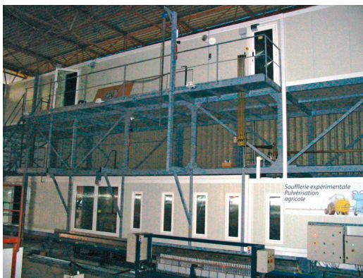
▲ Photo 2 – Tunnel de dérive.
