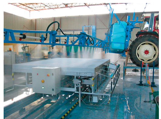
▼ Photo 1 – Banc de répartition.
