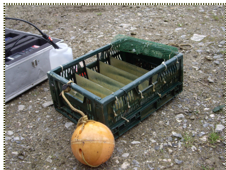
Photo 3. Dispositif utilisé pour la collecte du périphyton.
