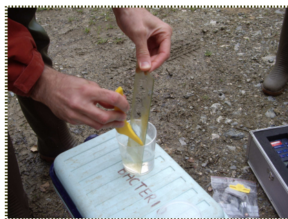
Photo 4. Grattage des lames à l'aide d'un racloir
