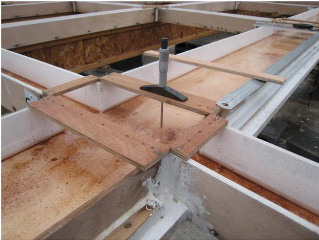
Figure 4.7 : Mesure des hauteurs d'eau à la jauge de profondeur
