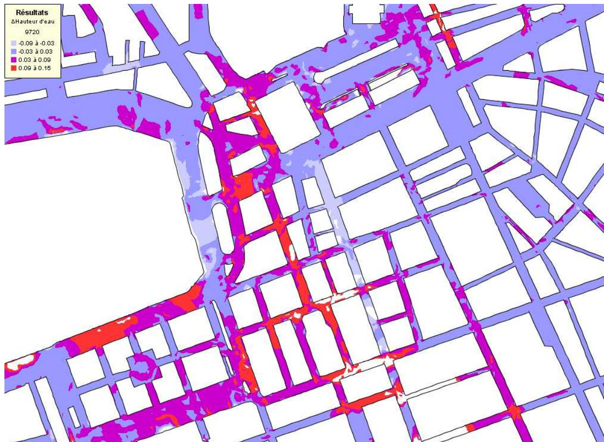
Figure 11.28 Comparaison des hauteurs d'eau au temps 9720s pour un calcul avec pluie uniforme répartie uniformément autour des bâtiments (méthode 2). Les valeurs sont résultat Reflux diminué du résultat Rubar20.
