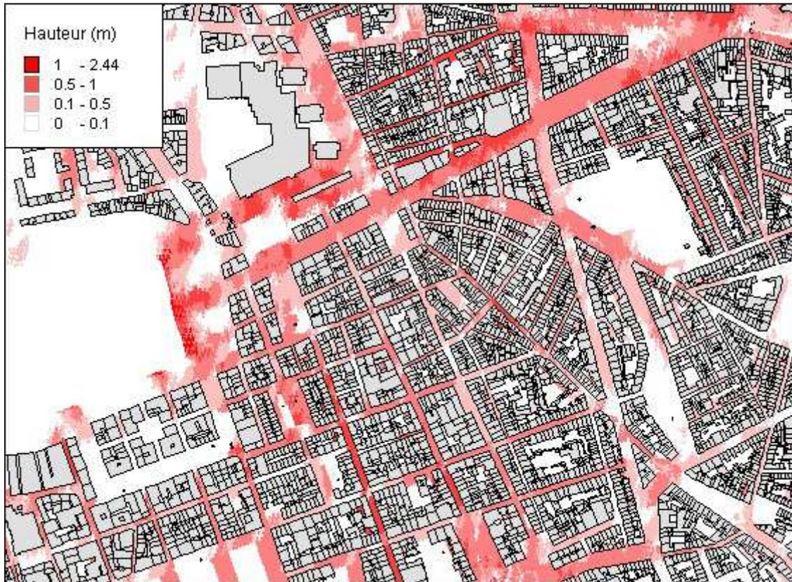
Figure 9.7 Répartition des hauteurs d'eau maximales dans les rues
