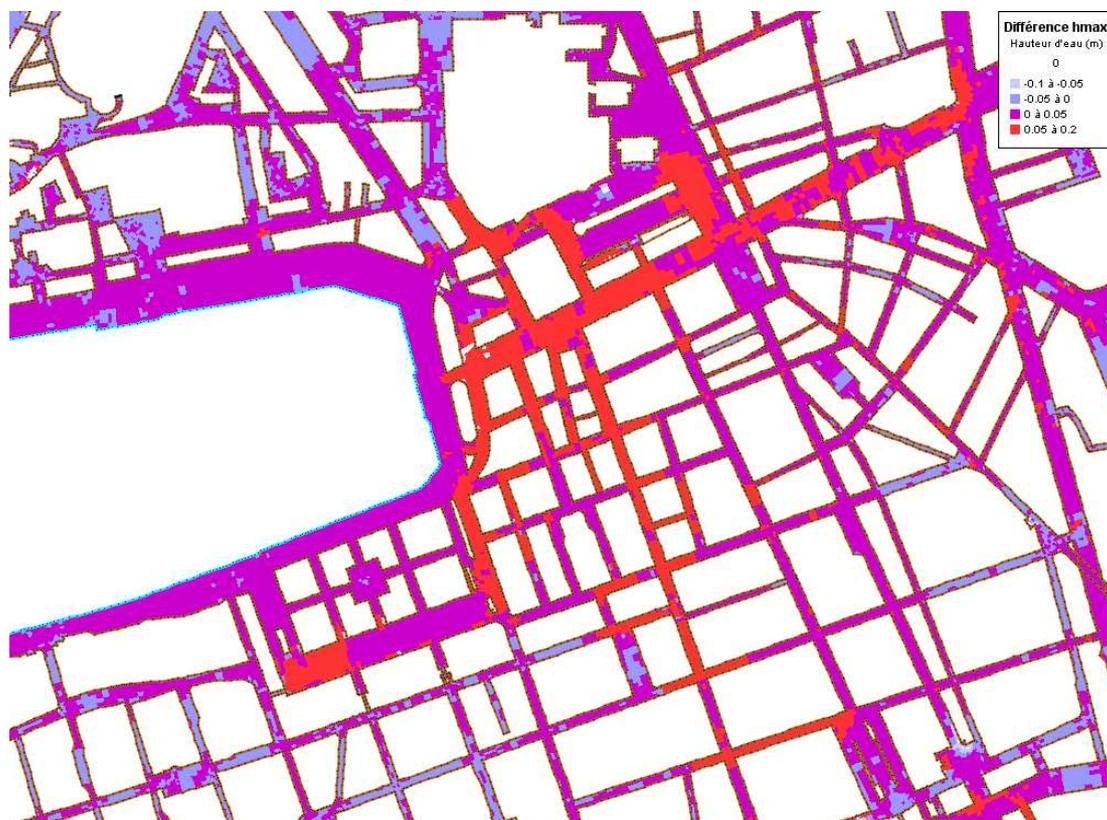
Fig.11.25 Comparaison entre répartition uniforme de la pluie supposée uniforme et répartition uniforme d'une pluie spatialement variable
