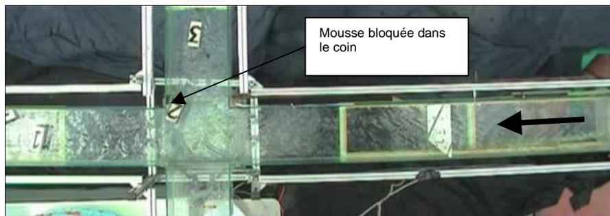
Figure 5.23. Blocage d'une mousse dans le coin
