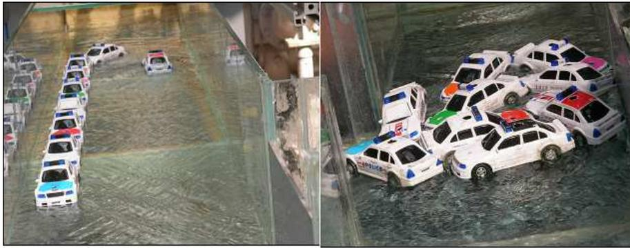
Figure 5.8. Photographie depuis le canal de fuite axial pour un stationnement en ligne
