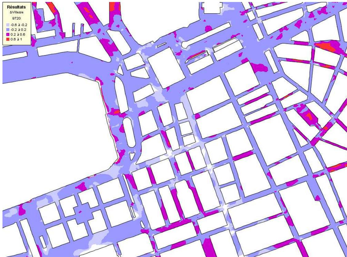
Figure 11.29 Comparaison des vitesses au temps 9720s pour un calcul avec pluie uniforme répartie uniformément autour des bâtiments (méthode 2). Les valeurs sont résultat Reflux diminué du résultat Rubar20
