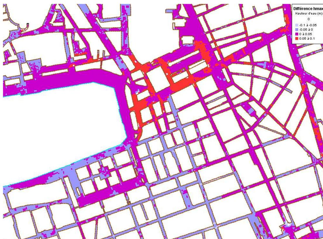
Fig.11.26 Comparaison entre répartition non uniforme de la pluie supposée uniforme et répartition uniforme d'une pluie spatialement variable.
