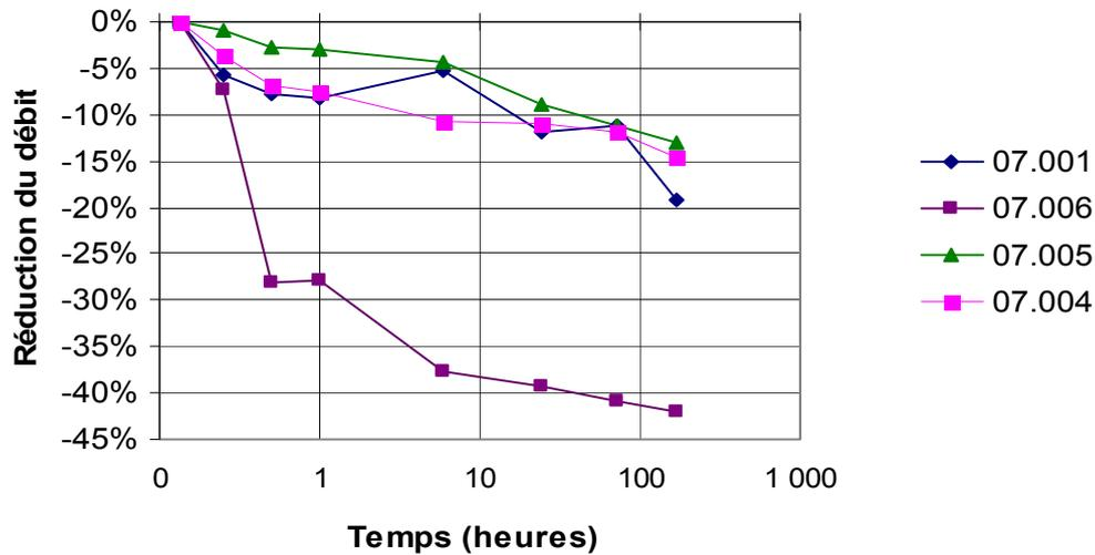
Figure 4. Synthèse des réductions de capacité de débit dans le plan entre deux plaques de mousse
