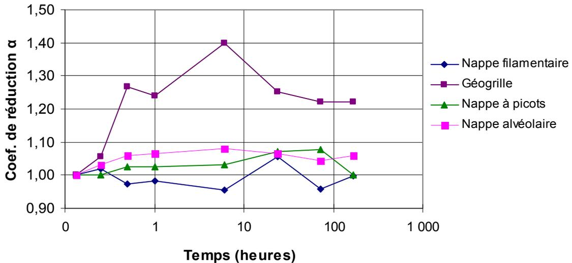
Figure 9. Courbes  $\alpha(t)$  pour les quatre produits testés sous une contrainte  $\sigma = 200$  kPa.
