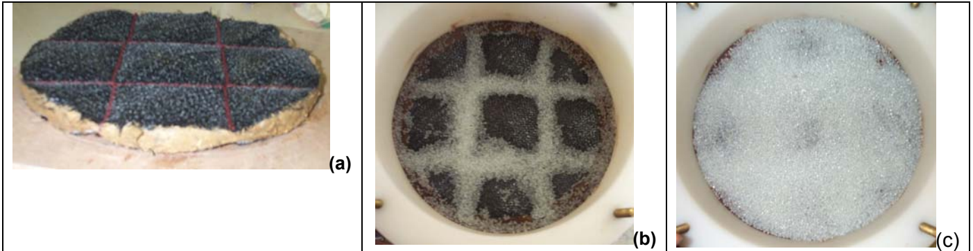
Figure 8. Comblement des creux du GSB2 dans l'œdoperméamètre : (a) état de surface du GSB2 hydraté sans confinement, (b) remplissage des creux par des billes de verre et (c) régalage de la couche de billes sur toute la surface d'essai
