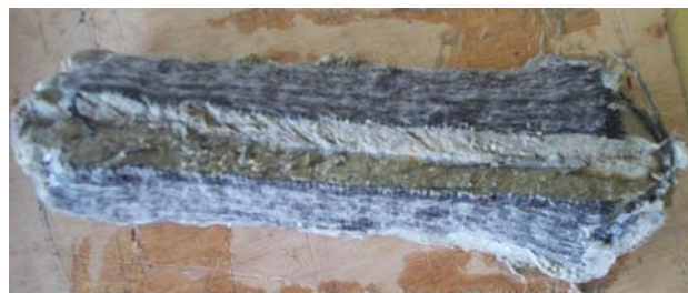
Figure 7. Éprouvette de GSB1 après saturation sans confinement et sous charge hydraulique nulle
