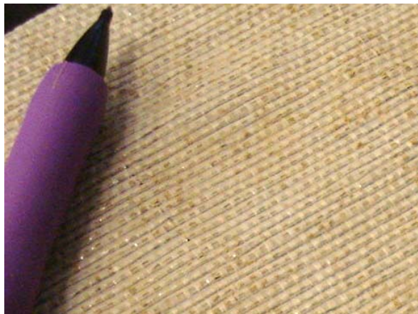
Figure 2. Aperçu de la surface du géotextile provenant du lé de GSB, imprégnée de bentonite sodique naturelle
