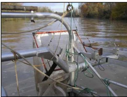
**Photo 4 :** Traîneau permettant d'échantillonner
