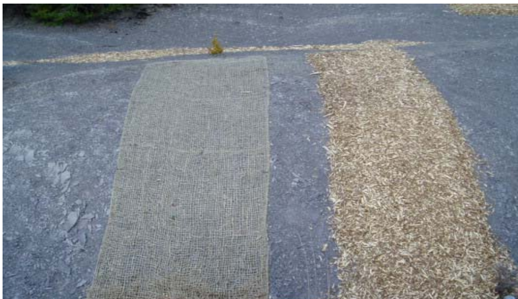
Figure n°17-Stabilité des plaques de BRF sur versants soumis à un ruissellement diffus.
