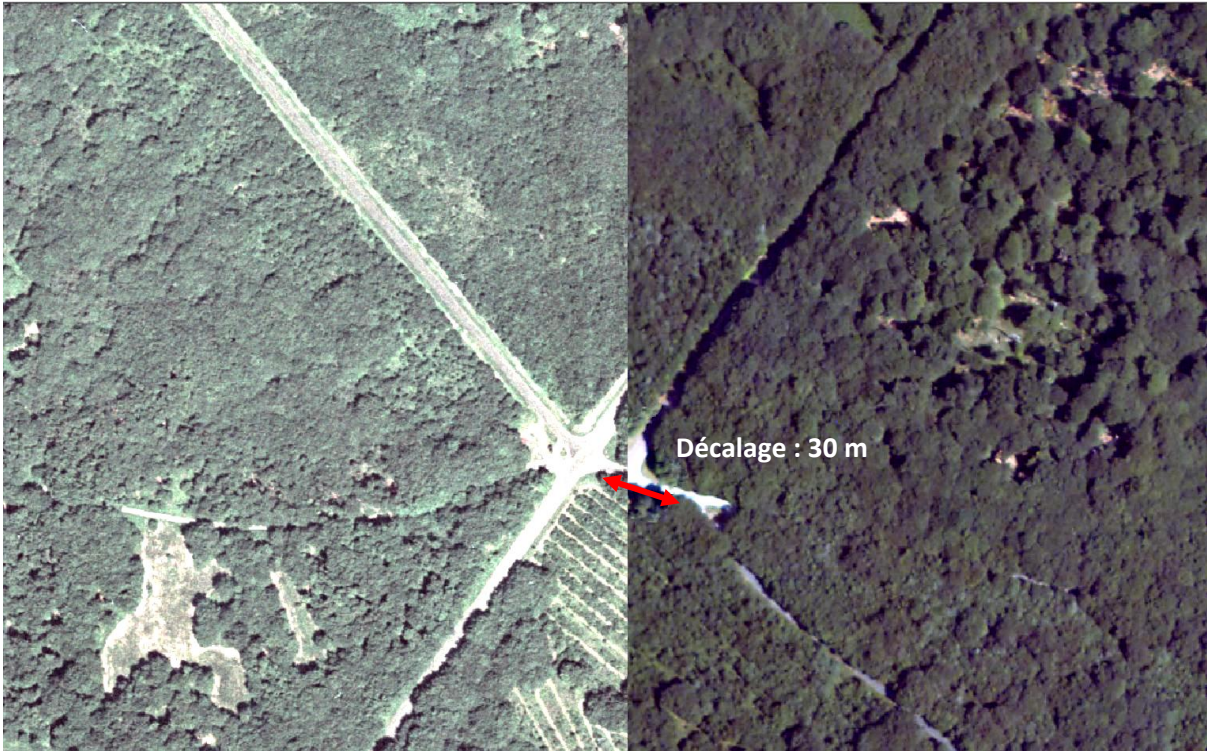
Figure 4. Exemple de décalage entre la Bd Ortho (à droite) et l'orthophoto de 1987 réalisée avec le MNS non corrigé.
