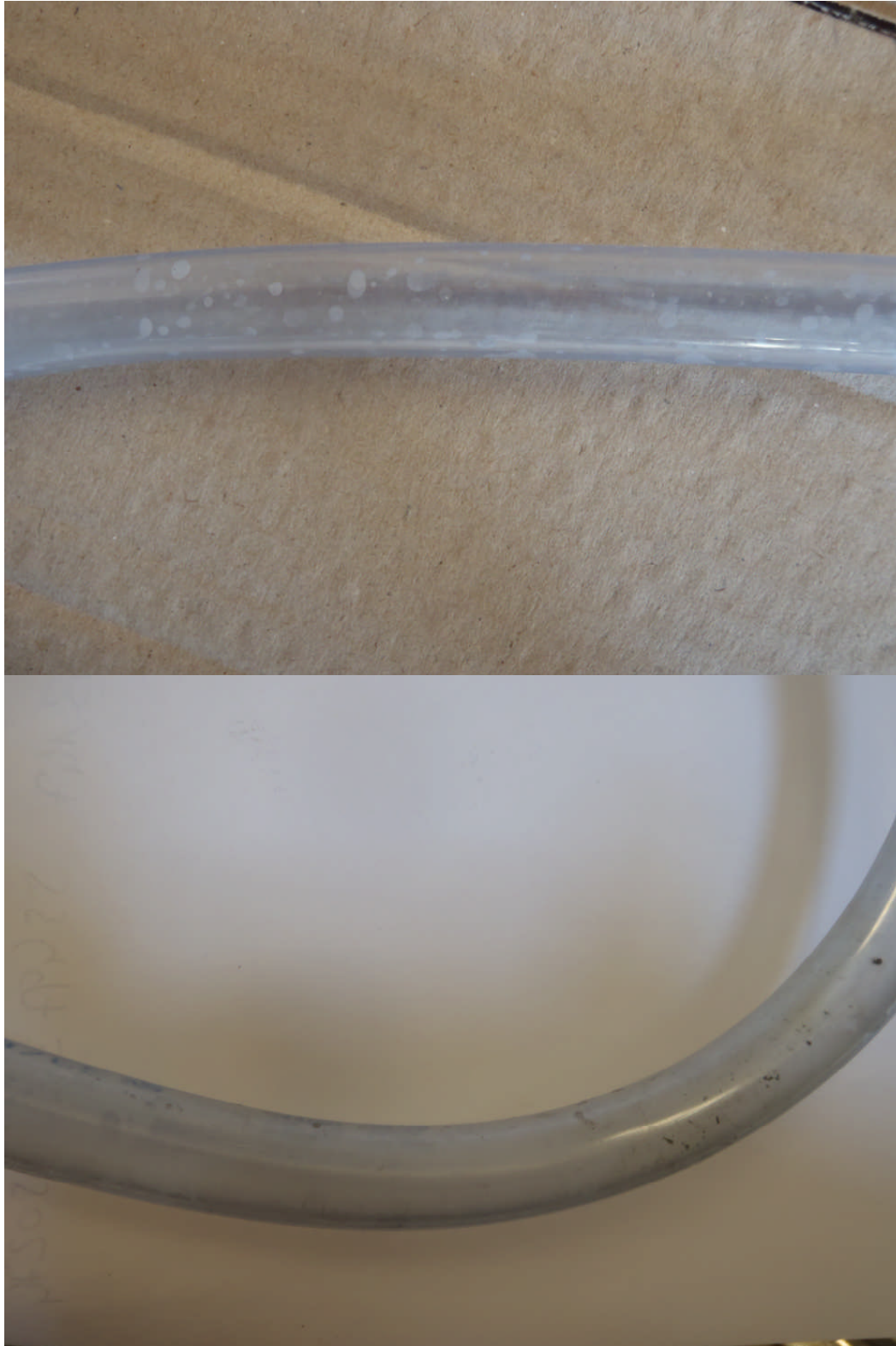
Figure 28 : tuyaux de recirculation d'air en sortie de réacteur de respirométrie solide, la paroi interne est recouverte de tache blanche ou de moisissure (taches sombres)
