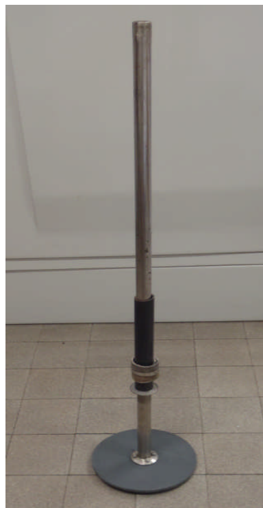
Figure 6 : schéma et photographie de l'outil de tassage mécanique utilisé
