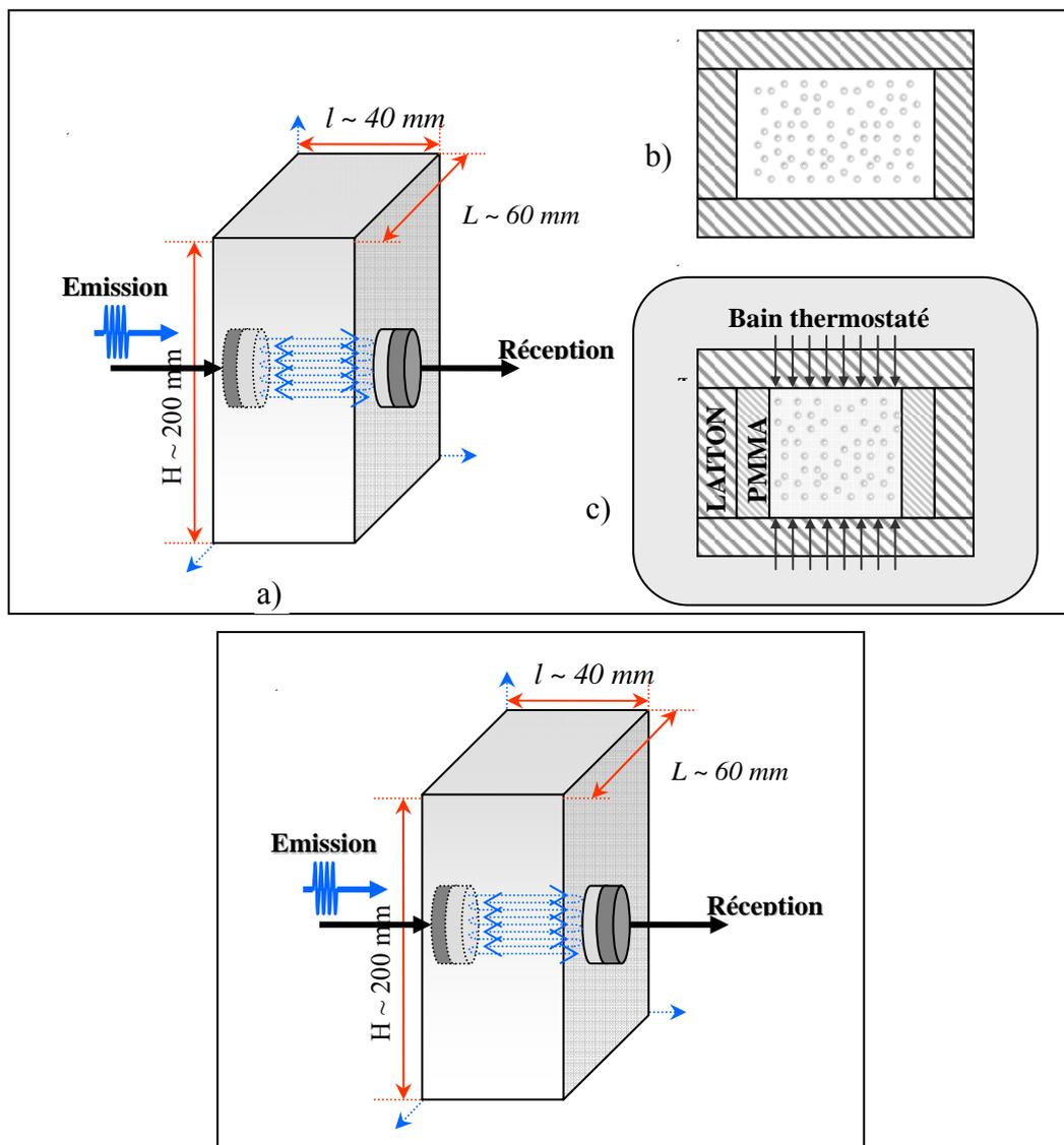
Figure 1 – Principe de la mesure, cellules utilisées : mesure de la relation entre fraction solide et vitesse du son..
